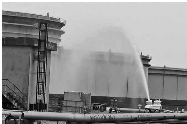
図6 仮想タンクへの放水状況
