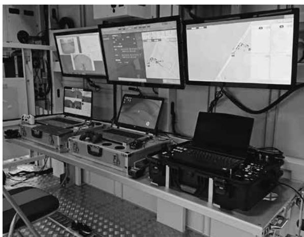
図4 搬送車両内に取り付けられた指令システム 左からカメラ画像表示画面、各種入力画面、石油コンビナートヤード内地図
