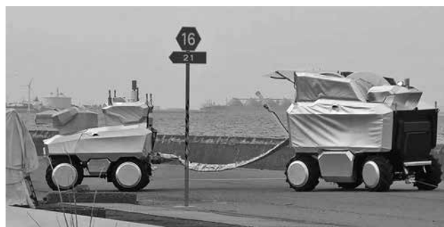
図5 ウォーター・キャノンの自律走行とタフ・リーラーの追従走行
